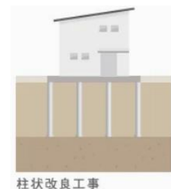
柱状改良工事
